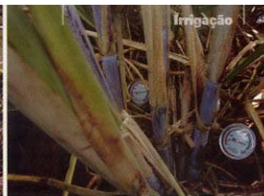
Tensiometro: equipamento mostra a necessidade de irrigação da lavoura
